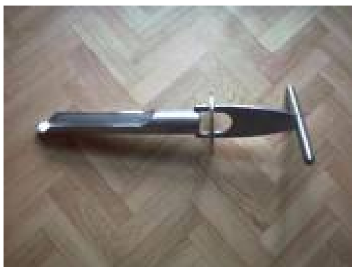
Рис. 3. Пробоотборник для взятия проб стволовой части мозга КРС производства фирмы «IZTL» [7]
