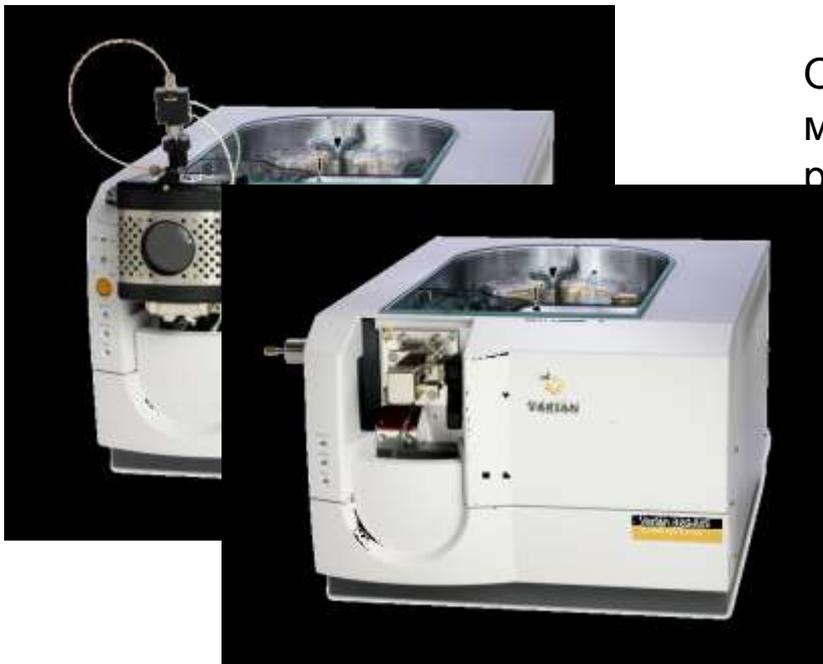
Основной прибор серии 300-MS. Единственная модель с возможностью работы в перестраиваемых режимах ГХ/МС и ВЭЖХ/МС. Пользователь имеет возможность приобрести прибор в вариантах:
