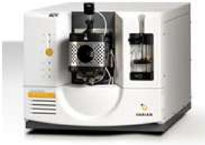
Масс-спектрометр 500-MS может оснащаться интерфейсами ESI и APCI и поддерживает все режимы tandemной масс-спектрометрии, типичные для "ионных ловушек". Прибор обладает возможностью быстрой (200 мкс) смены полярности в ходе анализа, что, в сочетании со скоростью сканирования (на уровне 15000 а.е.м./сек), позволяет легко оптимизировать параметры для оптимального определения аналитов разного типа, присутствующих в пробе.
