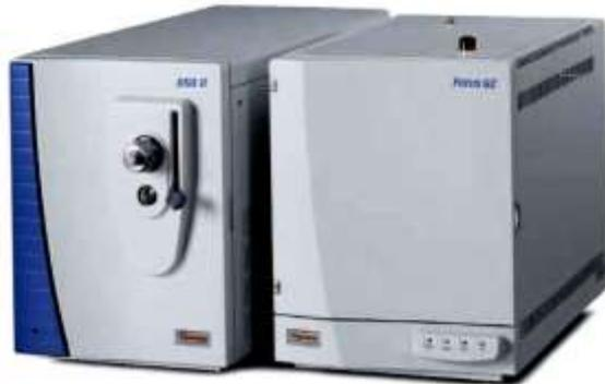
Энергия ионизирующих электронов регулируется в пределах от 0 до 130 эВ, ток эмиссии катода до 850 мкА
