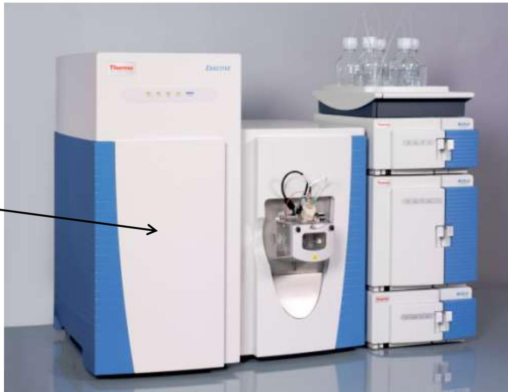
**Exactive** – это простая в использовании ВЭЖХ/МС система, позволяющая измерять точные массы ионов в каждом сканировании без прибегания к усреднению данных. Exactive полностью совместим с системами ЖХ сверхвысокого давления и обеспечивает точные измерения масс в любых применениях быстрой хроматографии.
