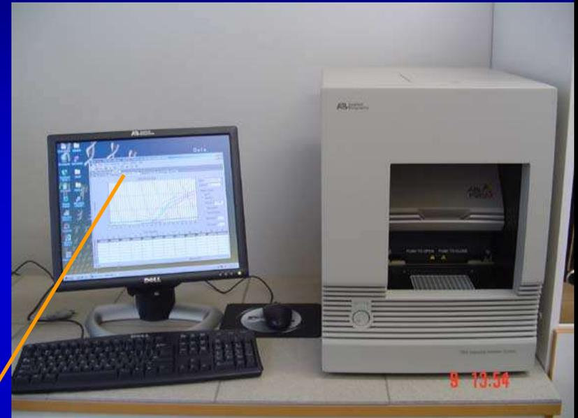
Прибор ABI Prism 7000 (Applied Biosystems) для выполнения анализов методом ПЦР в реальном времени.
