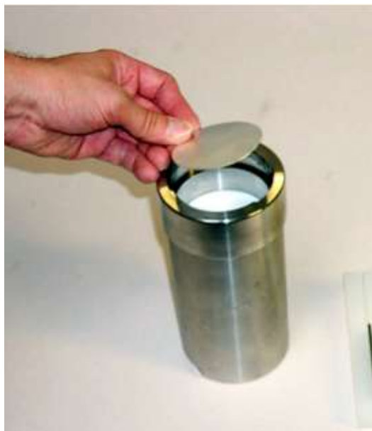
Закрыть TFM вкладыш алюминиевой пластиной
